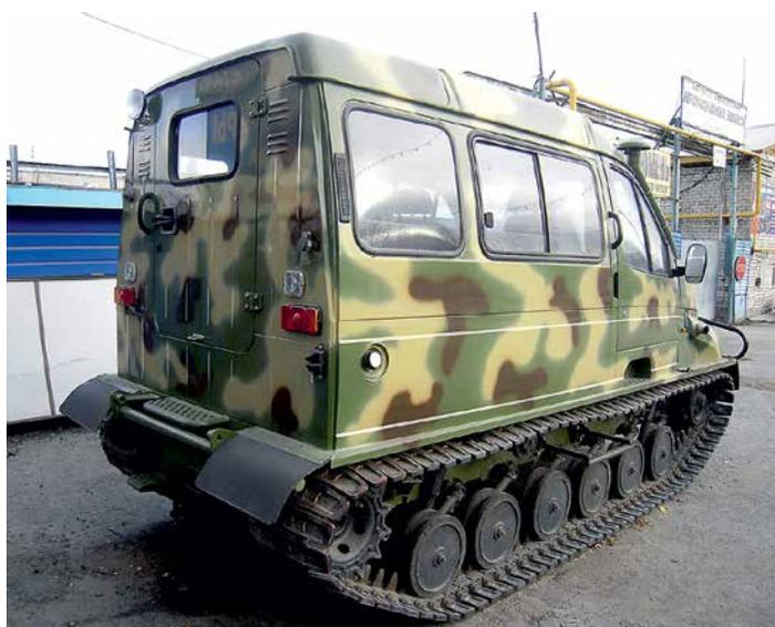
ГАЗ-3409 «Бобр» – это вездеход на гусеницах, предназначенный для эксплуатации в особо тяжелых дорожных и климатических условиях в районах Крайнего Севера. Благоприятными условиями для этого вездехода являются болота, затопленные лесные дороги и поляны. Благодаря своей компактности он может развернуться в густом лесу или на узкой просеке.
