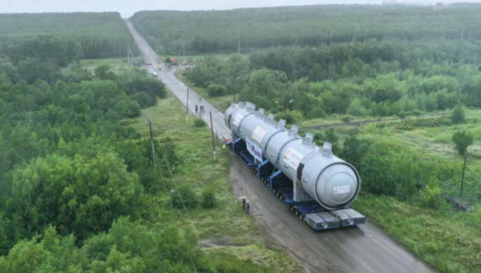
Сложнейшая логистическая операция по доставке гигантской «бочки»-автоклава в Амурск
